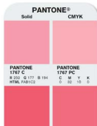
Extrait du nuancier Pantone Solid to Process : Correspondance entre tons direct et quadrichromie
